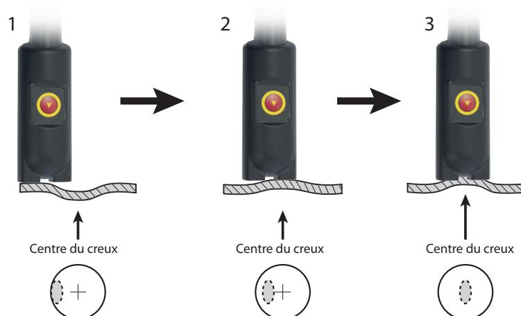
Dans certains cas, la profondeur de la bosse augmentera de taille pendant le chauffage (la tôle s'effondre sous l'effet de la chauffe). Si cela se produit, augmenter le périmètre de chauffe autour de la bosse et continuer à chauffer jusqu'à ce que la bosse commence à diminuer. Les bosses profondes nécessitent de chauffer de manière circulaire autour de la bosse pour revenir vers le centre.
